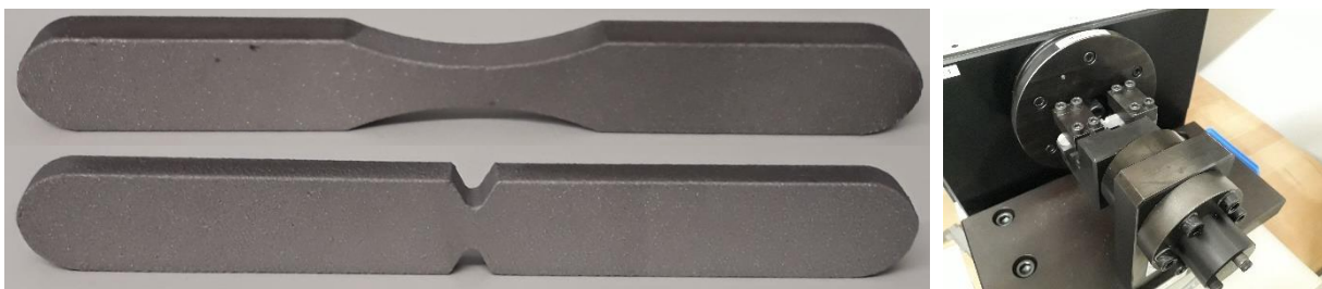
Abbildung 1 links: Werkstoffproben nach DIN 3928, rechts: Probe auf Resonanzprüfmaschine
