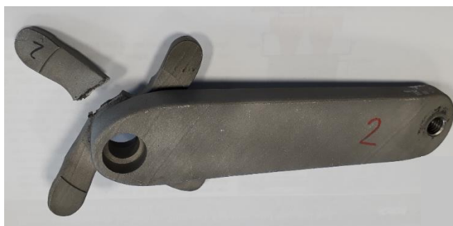
Abbildung 12: Maximale Spannung in der Simulation und Bruch im Bauteilversuch
